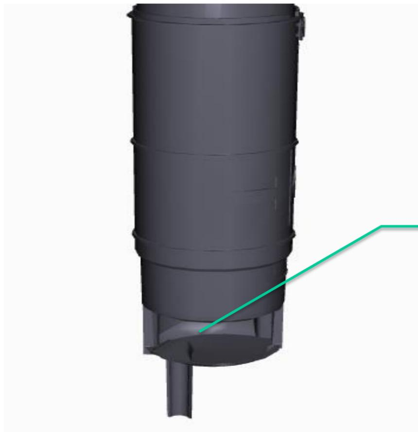
Переходник на 110/150 мм с измерительными отводами
