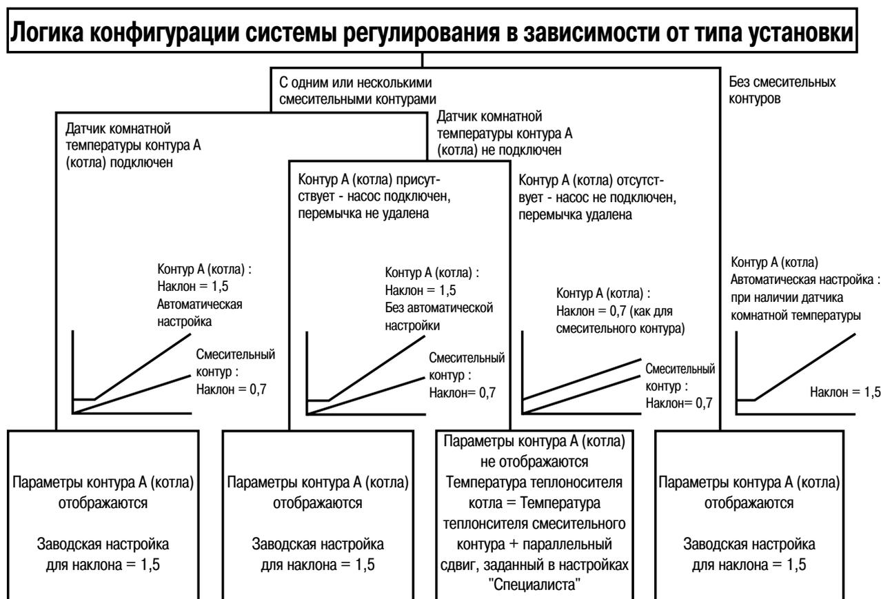
При использовании смесительного контура (контур А или С) необходимо подключить датчик температуры подающей линии после смесителя (\*). Подключение этого датчика, автоматически определяемое микропроцессором, предоставляет доступ ко всем настройкам данного контура и отображает программу для него.
